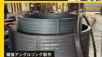
補強アングルリング製作
